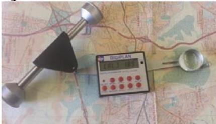
Figura 26 - Uso do planímetro eletrônico.
